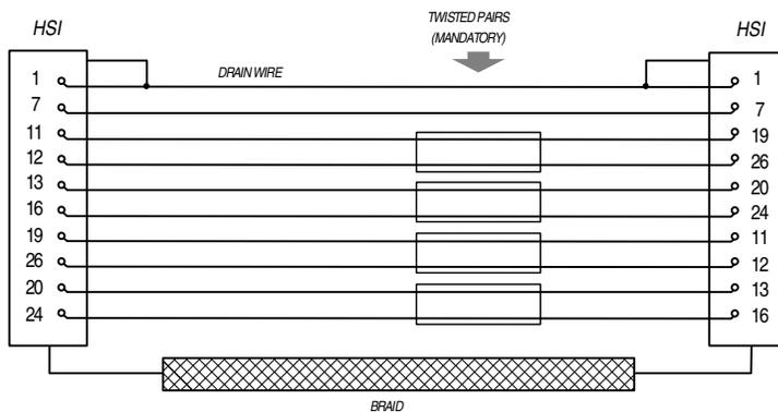
Figure 9. HSI X.21 Null-Modem Cable (300-032)
