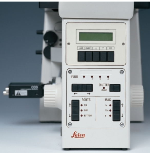
Front-Bedienelement für Fluoreszenz-Filter, Shutter, Photo TV-Ports und Vergrößerungswechsler
